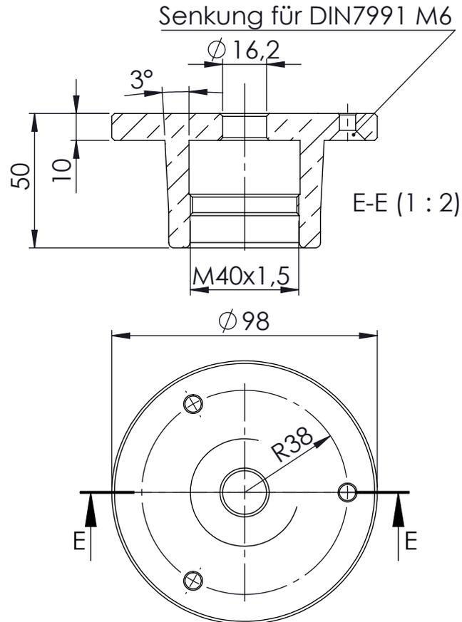
Die Abb. zeigt den **(1) Standard-Anschlußflansch**. Dieser kann geringfügig modifiziert werden, indem Sie weitere Adapter mittel 3 Senkkopfschrauben befestigen.
