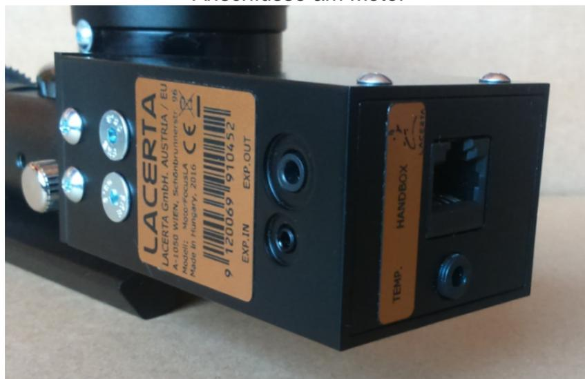
Oberseite: 2,5mm Stereo Buchse (zur MGEN Kamerabuchse)
