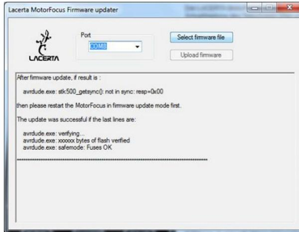
Zuerst wird der COM Port (eventuell im Geräte Manager nachschauen), und dann mit der **Select firmware** Schaltfläche das neue Firmware File ausgewählt.
