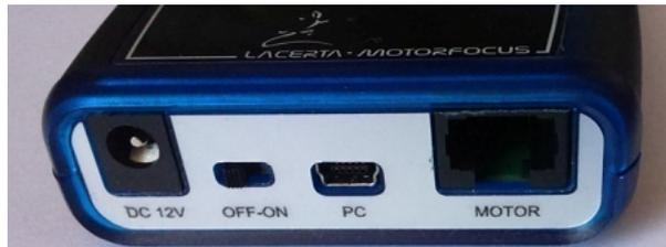
12V DC Buchse(5,5/2,1mm Mitte positiv) \_ Off-On Schalter \_ USB-B mini \_ RJ45
