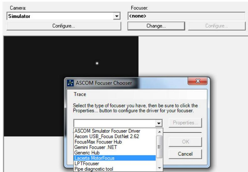
Wurde der Port schon früher mal ausgewählt, kann man einfach durch OK verbinden. Ein Signalton und Blinken des Displays zeigt die Verbindung an, und der Buchstabe "A" für Ascom erscheint in der Anzeige. Beim ersten Verbinden müssen zuerst die Einstellungen unter "properties" vorgenommen werden.
