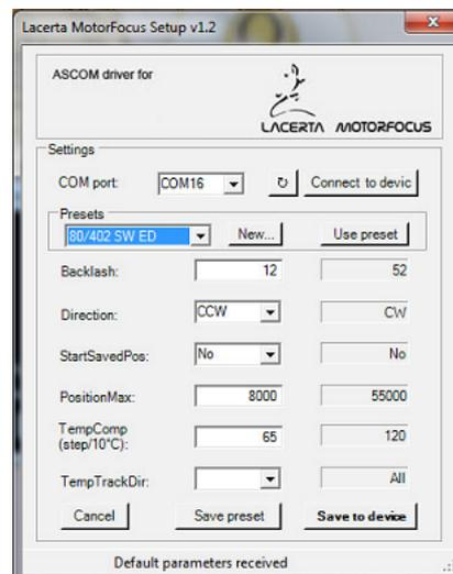
Der serielle Port des **LACERTA MOTORFOCUS** wird im COM Port Dropdown Menü eingetragen (Bei Unklarheit schauen Sie im Geräte Manager nach). Wenn die Verbindung erfolgt, werden die Einstellungen aus dem EEPROM geladen und können hier verändert werden. Mit "Save to device" werden sie im Controller gespeichert.
