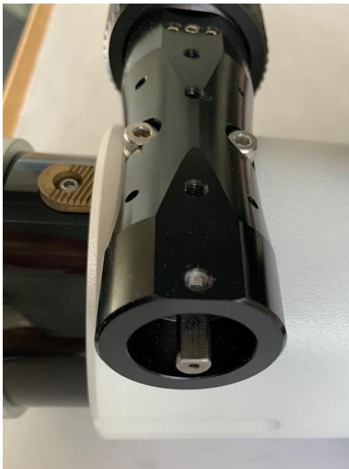
Dann das Fokussierrad drehen, bis in der Bohrung der Madenschraube die untere Madenschraube sichtbar wird, die das Fokussierrad fixiert. Diese mit einem 2mm Inbusschlüssel lockern. Ggf. befindet sich auf der Welle noch eine zweite Klemmschraube in 90° Abstand. Diese ebenfalls lockern und das Fokussierrad abziehen.
