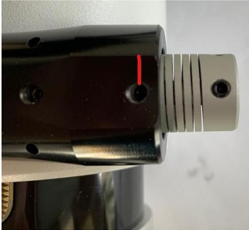
Die passende Kupplung aus dem EAF Set nehmen und so auf die Welle setzen, daß eine Madenschraube auf die abgeflachte Seite kommt. Diese durch das Bohrloch anziehen, die Kupplung um 90° drehen und die zweite Madenschraube ebenfalls anziehen.
