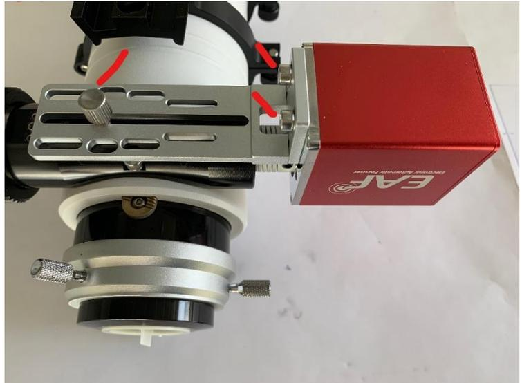
Nun den Haltewinkel vorerst locker am EAF befestigen und beide am Fokussiertrieb ansetzen. Dann den Haltewinkel so ausrichten, daß die beiden Wellen fluchten. Nun den Haltewinkel mit der vorhandenen Klemmschraube des Fokussierers befestigen und die Inbusschrauben am Motorgehäuse anziehen. Mit den motorseitigen Madenschrauben der Kupplung ebenso verfahren.
