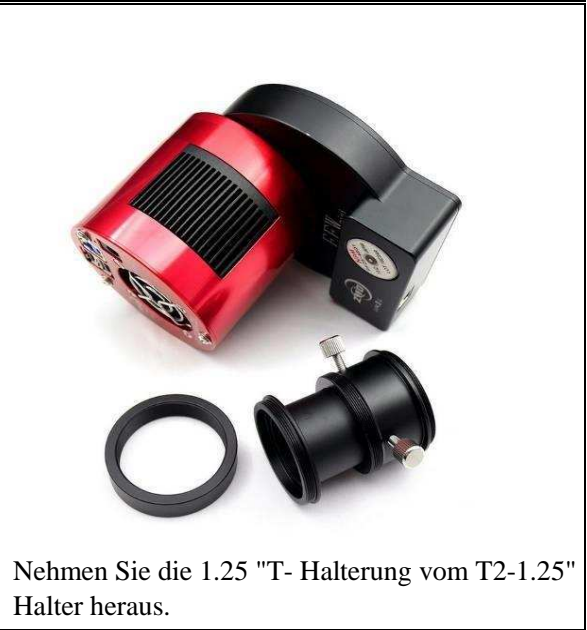
Befestigen Sie die Kamera wie abgebildet am EFW
