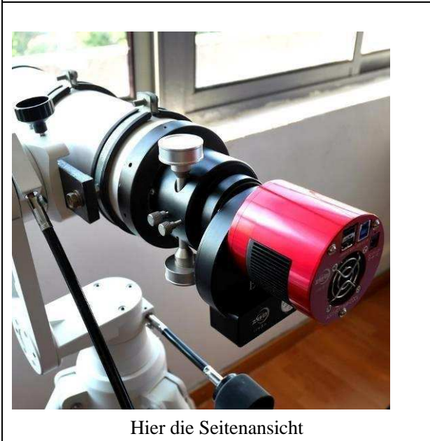
Installieren Sie die T-Halterung an der Rückseite des EFW
