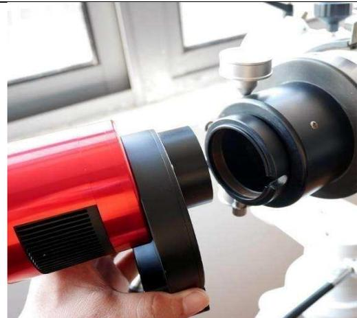
Der T2 Extender kann zur Befestigung an Teleskopen mit 2" Klemmung verwendet werden.
