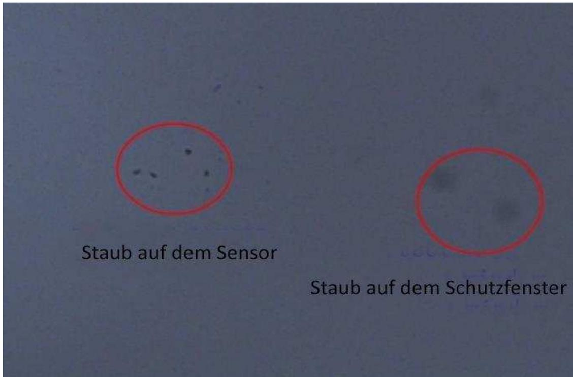
Der große dunkle Punkt auf dem Bild (rechts) sind die Schatten von Staub auf dem Schutzfenster.
