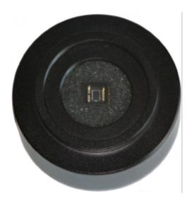
Um die Kamera mit dem Leitrohr zu verbinden, besitzt sie ein 4-5mm tiefes T2 Innengewinde. Ein T2? 1.25" Adapter kann hier zur Verbindung mit einem 1,25" (31,7mm) OAZ eingeschraubt werden.. Im T2 Gewinde befindet sich noch ein 1.25" Filtergewinde um einen Filter oder Staubschutz einzuschrauben.
