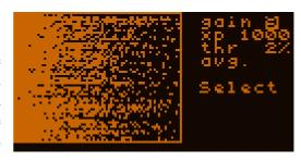
Jedes Pixel hier entspricht 10x10 Pixeln auf dem CCD-Chip, die Helligkeit ist von daher abgeleitet. Wie die Helligkeit genau bestimmt wird, darüber später mehr.
