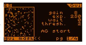
Auf allen 4 Unteranzeigen befindet sich links das Fenster mit dem 48x48 Pixel Bild des Leitsternes oder anderen Inhalts.
